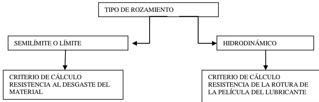
**Figura 3 Criterios de cálculo para cojinetes de deslizamiento**
