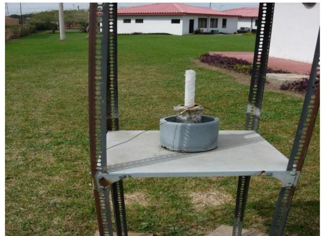
**Fotografía 3.** Colector de cloruros, denominado Método de la Vela Humeda.
