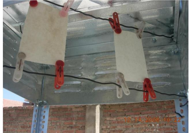
**Fotografía 2.** Placas alcalinas instaladas en la caseta para la determinación de deposición de  $\text{SO}_2$
